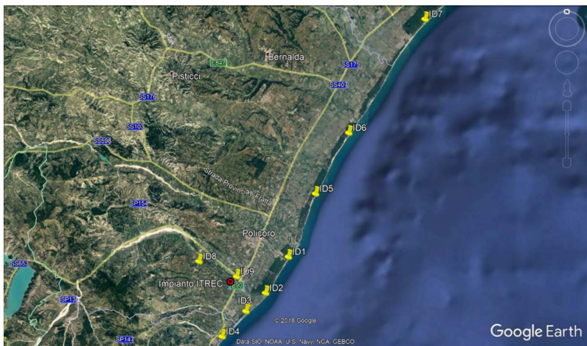
Figura 8 - Ortofoto con indicazione dei punti di misura del rateo di dose ambientale
